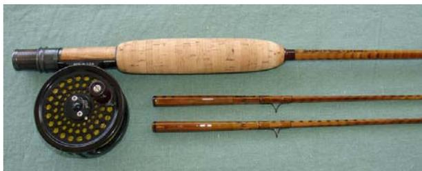
Ho allora iniziato a studiare il sistema per realizzare gli innesti in bamboo senza dover ricorrere ad attrezzi particolari soprattutto per la realizzazione dello swell. Volevo trovare il modo di costruire una ghiera bella, armoniosa e funzionale utilizzando gli strumenti che ogni rodmaker ha nel suo laboratorio; quindi con la planing form "standard", quella con le viti di regolazione ad interasse di 12,7 cm. ( 5" ).
